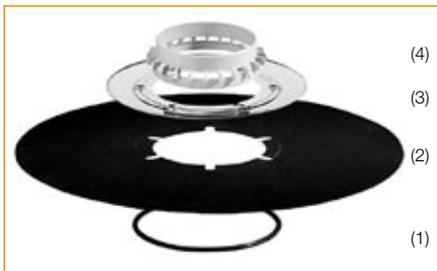
Poser ensuite le collet en acier inoxydable (3) (la face supérieure est repérée) sur la collerette, les orifices se superposent aux tétons en plastique de l'avaloir. Visser ensuite le collet en acier inoxydable à travers la collerette à l'aide des vis fournies. Clipser la crapaudine (4) dans l'avaloir. L'avaloir sera ensuite coupé en fonction de la hauteur du reste de la structure, puis emmanché sur la crapaudine.
